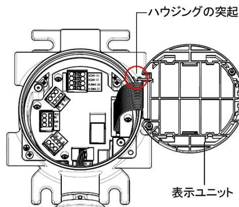
4 端子台基板にある端子台(TN2(Relay1)、TN3(Relay2)、TN4(Relay3))を引き抜いて外す
