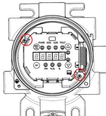
**11 蓋を時計回りに回して取り付け、六角穴付き止めねじ(M4)1本で固定する**
