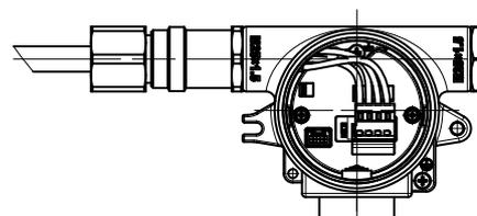
**8 蓋を時計回りに回して取り付け、六角穴付き止めねじ(M4)1本で固定する**
