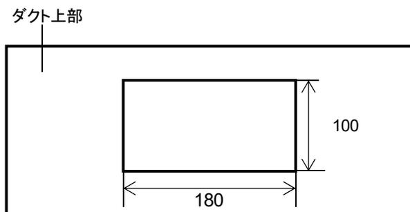
2 ダクトマウントキットにリモートセンサヘッド(GD-3)を挿入し、ねじ(M5)4本で固定する
