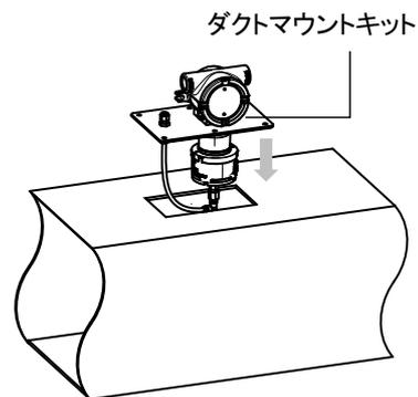
3 ダクトマウントキットをダクトの穴に挿入し、ねじ(M6)6本で固定する
